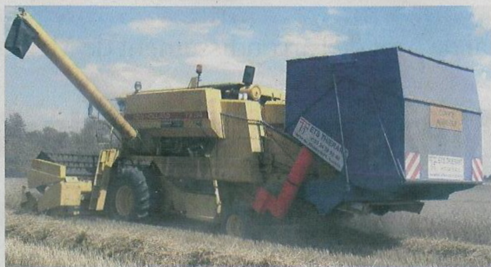
Le récupérateur : une auge placée dans le prolongement des grilles de ventilation.
